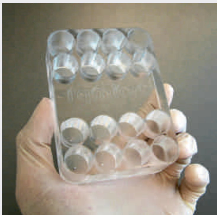
Fig. 2 Prototyp eines rqmicro-ALMS-Chips für vier gleichzeitige und unabhängige Legionellentests
